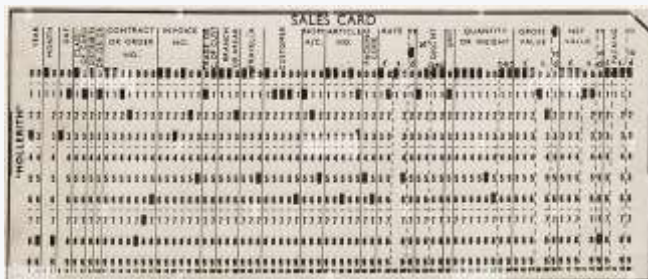
Obr. 1 – Dierne štítky typu Hollerith [8]
