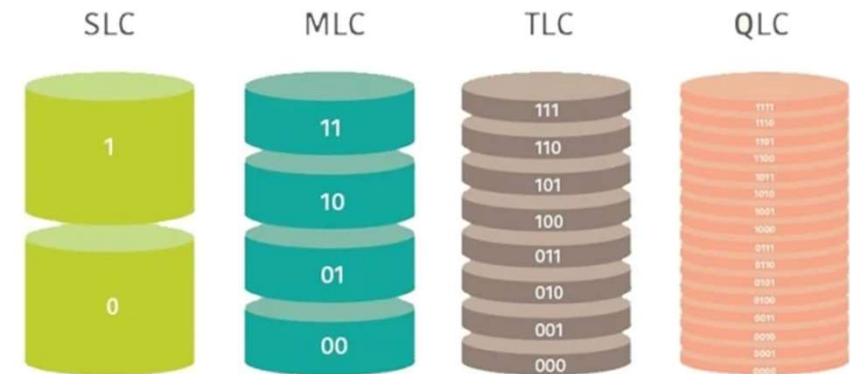
Obr. 9: Grafické znázornenie typov NAND flash buniek podľa počtu bitov na bunku
