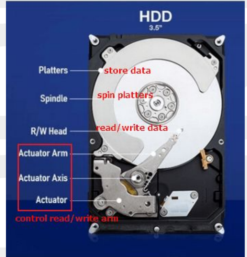
Obrázok 3: Pevný disk (HDD) s popisom komponentov. Znárodné sú hlavné časti disku, ako sú platne, čítacia/zapisovacia hlava, pohon motora a riadiaca elektronika.
