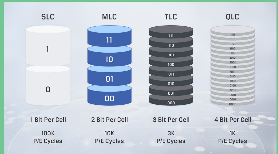
Obr. 2: Vzťah medzi počtom bitov v pamäťovej bunke a výdržou (počtom P/E cyklov).
